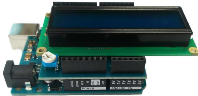
Figura 4. Utilizarea unui shield LCD pe o placă de tip Arduino Uno R3
