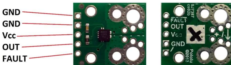
Figura 3. Traductor de curent realizat cu senzorul ACS711EX
