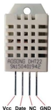
Figura 2. Traductor de umiditate realizat cu senzorul DHT22
