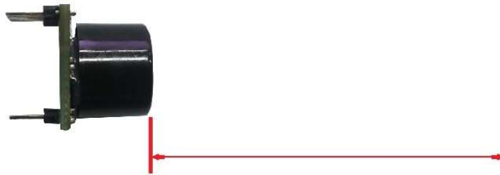
Figura 6. Măsurarea distanței cu traductorul LV-MaxSonar-EZ0
